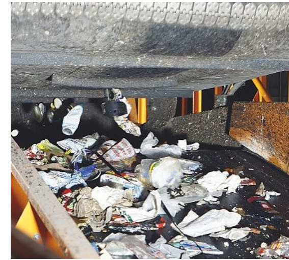
Am oberen Bildrand ist der große dunkle Überbandmagnetabscheider zu erkennen, der alle Metallteile anzieht.
