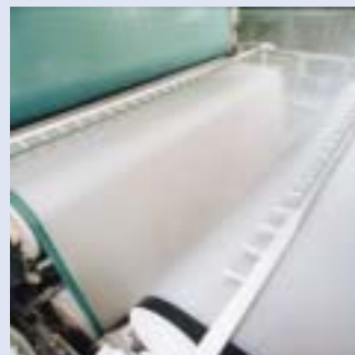
Die Bahnen laufen zusammen und werden vergautscht.
