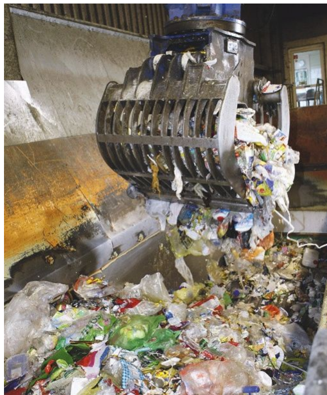
Der Sortiergreifer packt eine Ladung Müll auf den Aufgabedosierer.
