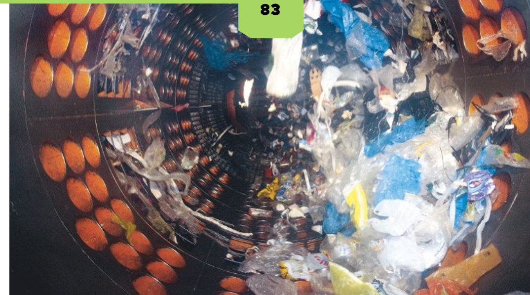
Blick ins drehende Trommelsieb, vorne sind die kleineren Löcher deutlich zu erkennen.
